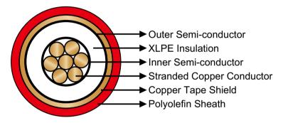
**Conductor:** Stranded copper conductor.
